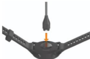
2. Подключите больший разъем USB-кабеля в зарядный порт USB. На экране отобразится текущий уровень заряда батареи.
